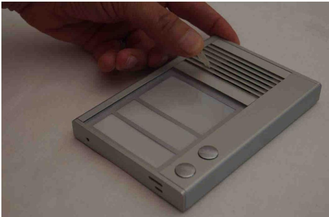
Schieben Sie das Sichtfenster leicht nach oben. Es wird sich circa 3 bis 4 Millimeter bewegen...
